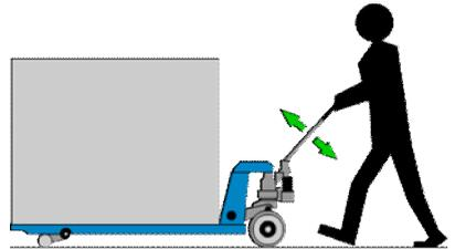
Груз поднимается при движении ручки гидравлической тележки.
