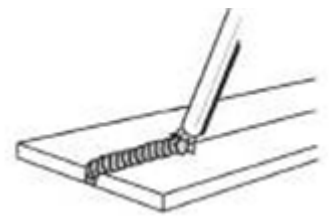
Рисунок 12. Нижнее положение при сварке
